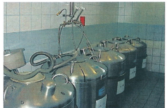
In diesen Containern wird der Gefriersamen in flüssigem Stickstoff bei minus 196 Grad Celsius aufbewahrt. Er ist unbeschränkt haltbar.
